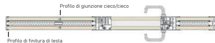
Horizontal section Wall | Blind door
